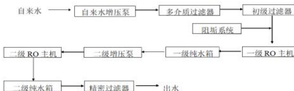
图 2-3 纯水制备工艺流程图
